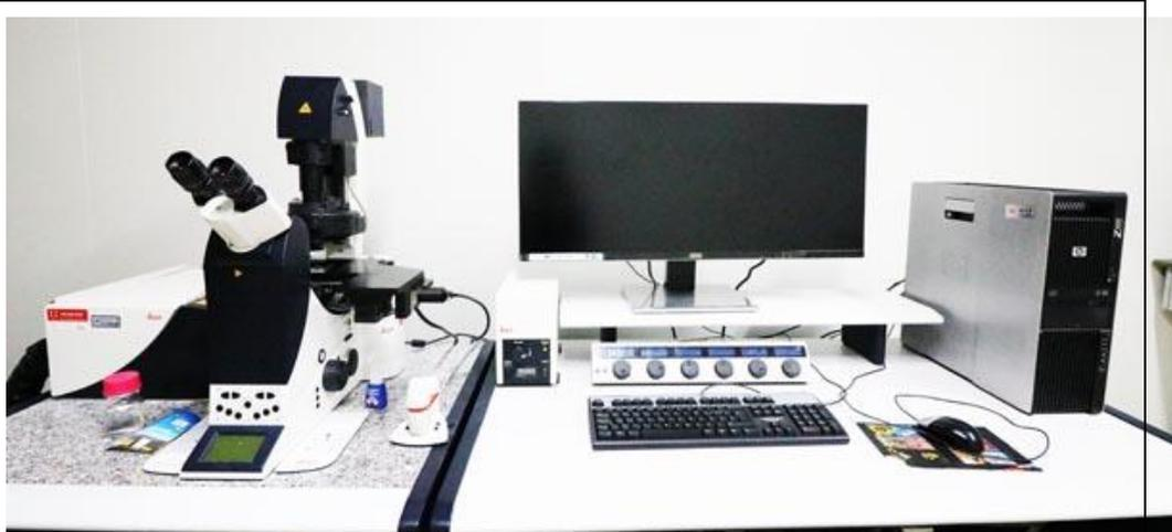
**超高灵敏度激光共聚焦显微镜**
